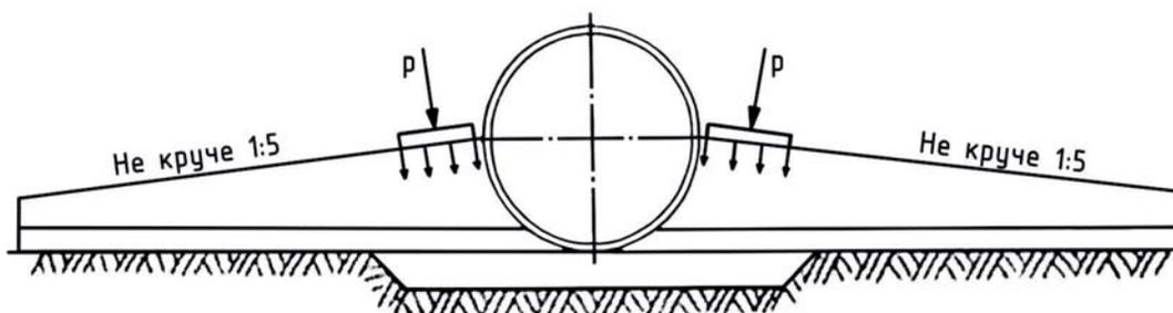
Рисунок 5 – Схема засыпки и уплотнения грунта наклонными слоями
