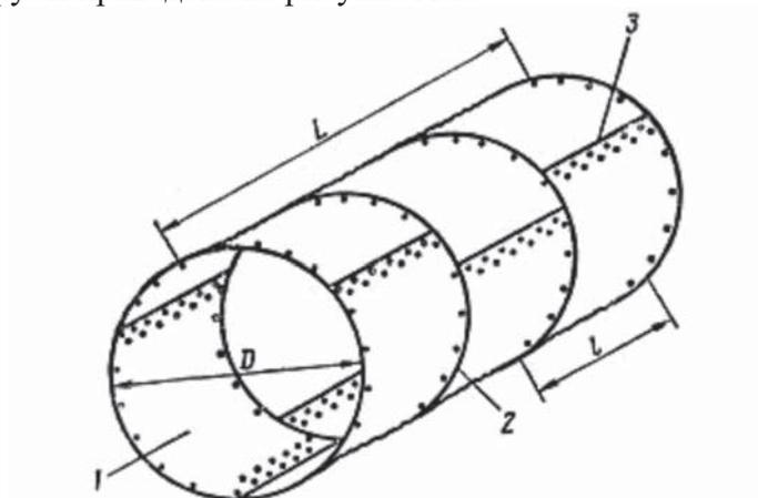
1 – элемент; 2 – поперечный болтовой стык; 3 – продольный болтовой стык;
