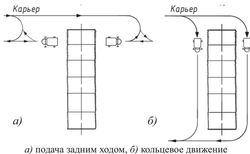
Рисунок 4 – Схемы движения автосамосвалов в процессе отсыпки грунта
